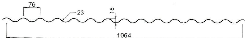
Abbildung 3: Querschnitt des Stahl-Wellprofils W1/1064 (18/76)
